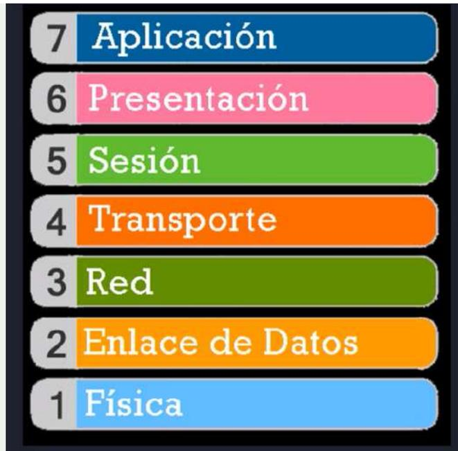
El modelo de referencia OSI proporciona una arquitectura de 7 niveles o capas, alrededor de los cuales se pueden diseñar protocolos específicos que permitan a diferentes usuarios comunicarse abiertamente.
